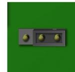
Sollte das Gerät am Ende einer Leitungskette angeschlossen werden, muss der Abschlusswiderstand aktiviert werden:
