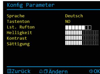
Die Einstellung von Helligkeit, Kontrast und Farbsättigung erfolgt in den Benutzereinstellungen im Ruhemodus (Sprechen und Video aus). Die Gesprächslautstärke kann nur durch eine Elektrofachkraft eingestellt werden.
